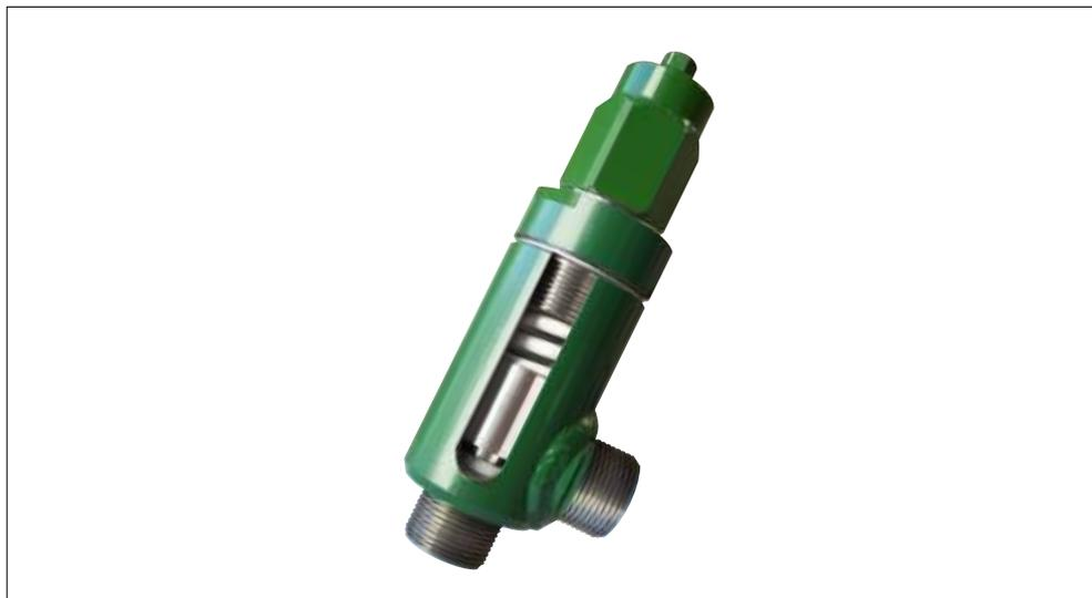
Las válvulas Hecam son válvulas de alivio convencionales de acción directa y cuyo desempeño depende de la contrapresión. Especialmente diseñada para proteger recipientes y demás componentes de una instalación frigorífica contra excesos de presión. Las válvulas son provistas a la presión solicitada por el cliente en valores que comprende entre 5 kg/cm<sup>2</sup> y 18 kg/cm<sup>2</sup>.
