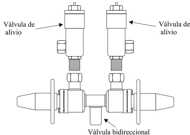
Cuando el vástago de la derecha es girado hasta el tope en el sentido contrario a las agujas del reloj y el vástago de la izquierda es girado en el sentido de las agujas del reloj, queda en servicio la válvula de seguridad B. Si se realizara la operación contraria quedaría en servicio la válvula de seguridad A. Para poder girar los vástagos se deben sacar los capuchones girándolos en sentido antihorario y colocarlos invertidos haciendo coincidir los cuadrantes en los vástagos.
